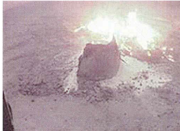
Natriumhydrid brennt kontrolliert ab
