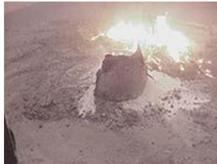
水素化ナトリウムの燃焼実験
