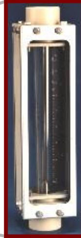
この事例では、ロタメーターの下流側の配管で閉塞が起こった経歴があった。過去には数回、150 psig (1 MPa(G)) スチームを使って閉塞を除去するのに成功していた。再度閉塞が起こった際、スチームが使用されたが今度は結果が異なってしまった!
