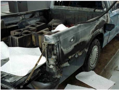
Un client faisait le plein d'un bidon d'essence non mis à la terre et qui se trouvait dans la boîte arrière d'un camion lorsque les vapeurs s'enflammèrent suite à une décharge d'électricité statique. L'incendie causa de sévères dommages au camion et à la station d'essence. Le client subit de graves brûlures aux deux jambes et cela aurait pu être bien pire encore si quatre témoins n'avaient pas réussi à éteindre les flammes à l'aide de leurs propres vêtements.
