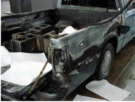
어떤 고객이 트럭 적하지역에서 접지되지 않은 휘발유 용기 강통에 충유하다 증발 기체가 정전기 방전에 의해 발화되었습니다. 화재는 트럭과 주유기에 심각한 피해를 입혔습니다. 그 고객은 양 다리에 중화상을 입었는데 만약 주변에 있던 네 명의 사람들이 자신들의 옷으로 진화에 안간힘을 쓰지 않았다면 훨씬 더 치명적일 뻔 했습니다. 이 사고는 우리들에게 인화성이나 가연성
