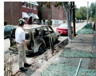
数多のボンベや部品が地域一帯に飛散し、歩道・前庭・裏庭・中庭・駐車場や車の下で発見された。被害の中には、焼けた空の商業ビル、燃えた車、居住用建物の壁の3 feet(90cm)の穴、壊れた窓、その他居住用および商業用建物の破損などがあった。ボンベの部品は800 feet(240m)離れたところでも発見された。
