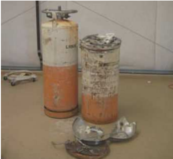
Cylindre intact au côté du cylindre s'étant rupturé
