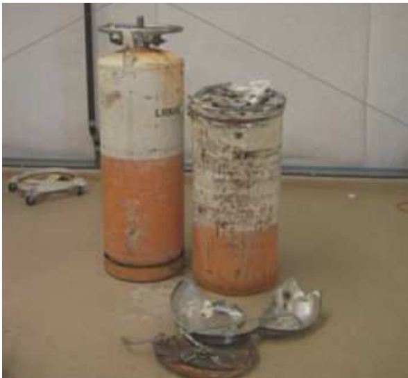
Cilindro intacto y restos del cilindro dañado.
