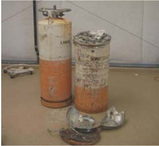
En intakt gastub och resterna av den brustna gastuben
