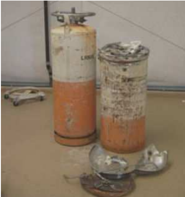
ถังก๊าซที่ยังไม่เสียหายและถังที่เสียหาย
