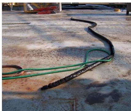
洋上採油プラットフォームで、作業員が可搬式薬品移送タンクからホースで繋がれた貯槽にメタノールを移していた。貯槽に重力で送入するためタンクをクレーンで吊り上げたとき、メタノールがホースの孔から噴き出し最上階デッキで着火した。横方向に噴き出したメタノールも第二デッキ上にあった移送場所直下のコンプレッサーの排気の熱で着火した。(慌てた)作業員が足でバルブを閉じようとしたとき移送タンクのサイトグラスが破損し火が大きくなり、他の二つの薬品移送タンクのリリース弁が開いていたため更に広がった。
