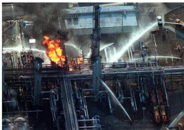
制换热器变得脆弱了，另外来自突然流动的热油所带来150°C的温差造成了换热器产生了附加的应力。这样就导致了该热交换器的脆裂。大约有10吨多的易燃气体释放出来，形成气体云雾，随后被一只加热器点燃。爆炸和大火导致两人死亡，八人受伤，大火持续燃烧了两天。澳大利亚大部地区的煤气供应中断了三个星期，对大约四百万居民造成了影响。总共的经济损失估计超过10亿澳元。
