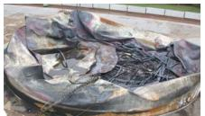
Während der Befüllung mit Dieselöl explodierte ein 12.700 m3 Schwimmdachtank und geriet in Brand. Zum Zeitpunkt des Ereignisses enthielt er ca. 1.100m3 Diesel. Vorher war er mit Benzin gefüllt. Der Brand dauerte 21 Stunden und beschädigte zwei weitere Tanks in der Nähe. Niemand wurde verletzt. Der Sachschaden betrug mehr als 1,5 Millionen €, umliegende Ortschaften wurden evakuiert, umliegende Schulen wurden für zwei Tage geschlossen.
