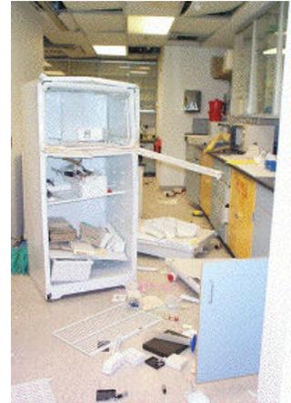
termostato per il controllo della temperatura ed altri cablaggi interni e componenti elettriche. Una scintilla da uno di questi può causare l'accensione dei vapori infiammabili provocando un'esplosione.
