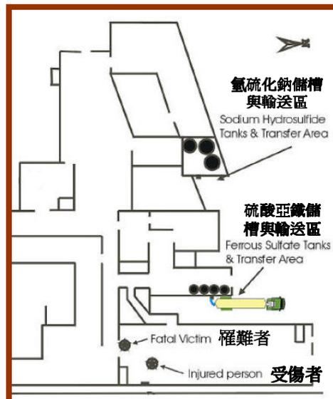
一輛裝載氫硫化鈉 (sodium hydrosulfide) 溶液的槽車在大約上午3:30到達某工廠，要卸料至右圖中靠近上方中央的儲槽。卡車司機之前未曾到過工廠，故要求工廠值班主管協助。值班主管曾被告知將有化學品運到，而設想此化學品是硫酸亞鐵 (ferrous sulfate) - 這是在他值班時唯一曾經接收過的化學品。他指揮卡車司機到硫酸亞鐵卸載站 (如右圖所示卡車位置)。值班主管未核實槽車化學品的一致性，雖然交貨單確有正確註明其內容物為氫硫化鈉。值班主管未閱讀便簽署了交貨單而離開該區域。無任何工廠員工留在卸載區照料。
