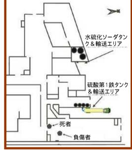
トラックが示されている、硫酸第一鉄の荷降ろし場を指示した。シフト責任者は、積荷書類には内容物は水硫化ソーダであると正しく表示されていたにも拘わらず、トラック中の化学品の特定確認をしなかった。 責任者は積荷書類を読みもせず署名してその場を離れた。 プラントの従業員は誰も荷降ろし場には残っていなかった。
