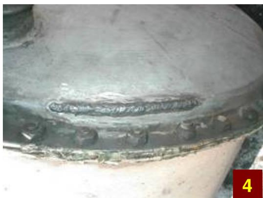
某一壓縮空氣儲槽失能(failed)而爆開，吹掉儲槽底部 (1)，並將碎片射至一道混凝土牆而穿入牆壁 (2)。事件隨後的調查揭出了幾個有關儲槽狀況的嚴重問題，包括於此次失能所在的儲槽底部的嚴重腐蝕與生鏽(3)，和以前某時對儲槽所作的一處不當的銲接修理 (4)。雖然銲接修理並未導致此一事件，它卻是不當維護與檢查的表徵，而有可能造成儲槽失能。幸運地，當儲槽失能時，無人在此區域故無人受傷。
