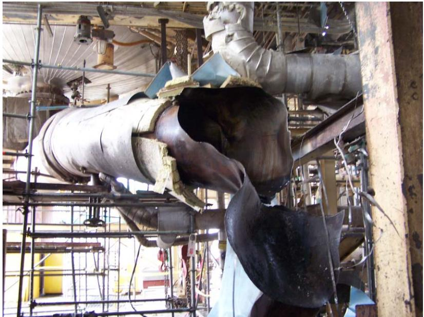
In dié geval was die nitraatsouthitteruivloeistof relatief reaktief, maar in menige prosesse kan die proseschemikalië hewig reageer met gewone hitteruivloeistowwe soos water, soutwater, stoom, etileenglikoloplossings of hitteruilolie. Die reaksies kan hitte, gas en druk veroorsaak.
