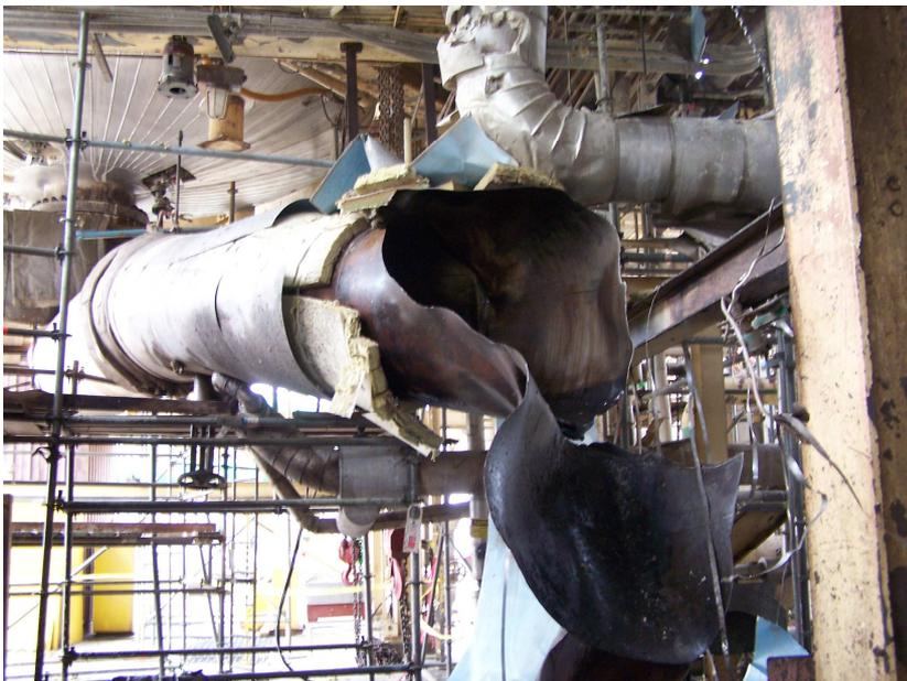
Este incidente envolveu um fluido de transferência de calor relativamente reativo (solução de nitrato), mas muitos materiais de processo podem reagir com outros fluidos comuns de transferência de calor, tais como: água, vapor, fluidos utilizados em sistemas de refrigeração, soluções de etileno glicol, ou óleos para transferência de calor. As reações poderão produzir calor ou gerar gás e provocar a elevação da pressão.
