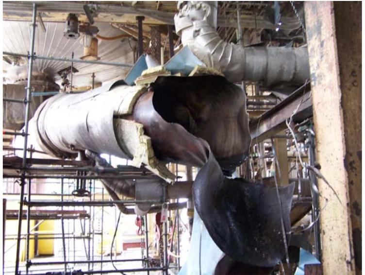
Felizmente, ninguém se feriu. O incidente mostrou como era crítico evitar-se a fuga de sais de nitrato, a detecção dessas fugas e ter um procedimento de paragem de emergência no caso de uma fuga deste tipo.
