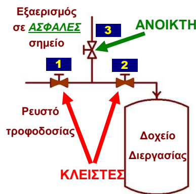
2. Βάνες Double Block and Bleed για απομόνωση ρευστού
