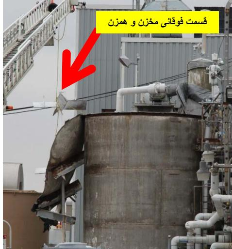
مخزنی با فشار اتمسفریک محتوی پلی وینیل فلوراید مایع بود. بخارات قابل اشتعال آن در فضای مخزن پراکنده شده بود. یک جوشکار به همراه سرپرست خود در بالای این مخزن اتمسفریک مشغول تعمیر پایه همزن بودند. انفجار ایجاد شده باعث مرگ جوشکار و زخمی شدن سرپرست او شد. موج ناشی از انفجار باعث جدا شدن سقف مخزن شد که همزن نیز به آن آویزان است. بررسی های CSB حاکی از آنست که بخارات وینیل فلوراید از طریق سایر تجهیزات به داخل مخزن نشست یافته و عملیات جوشکاری سبب احتراق آن شده است.
