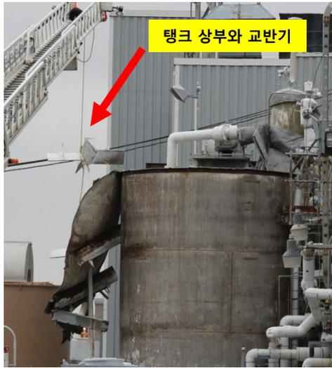
계약직 용접사와 공사감독이 가연성 농도의 비닐플루오르화물 증기가 찬 폴리비닐 플루오르화물 반죽 (polyvinyl fluoride slurry)을 저장하는 대기압 탱크 위에서 교반기 지지대를 보수하고 있었습니다. 용접으로 인한 폭발로 용접사는 사망하고 감독은 부상을 당했으며 탱크 상부 대부분이 날라가고 교반기는 탱크 옆에 매달려 있었습니다. 미국의 화학 안전 위원회(CSB)는 사고 조사를 통해 연결된 프로세스 탱크로부터 폴리 비닐 플루오르화물 증기가 감지되지 않은 채 저장탱크로 누설되었고 용접작업으로 인해 점화된 것으로 발표했습니다.
