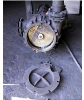
يجب أن تكون الإجابة "نعم" أو لن يكون لدينا موضوع لهذه المنارة! مضخات الطرد المركزي في الصور كلها مضخات مياه انفجرت. لم تحدث الانفجارات بسبب أي تلوث أو تفاعل كيميائي بشيء لم يكن من المفترض أن يكون في المضخة. في الواقع، انفجارات من هذا القبيل حدثت مع ماء نقي - مضخات تغذية الغلايات بالمياه، مضخات المكثفات، ومضخات الماء منزوع الأيونات.
