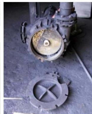
答えは“イエス”でなければならない。そうでなければこのBeaconの題材にはしないだろう！写真の遠心ポンプは、全て爆発した水ポンプである。この爆発は、ポンプ内に存在すると思われる物による汚染や化学反応によって起こされたものではない。事実、このような爆発は、高純度の水—ボイラ給水ポンプ、凝縮水ポンプ、脱イオン水ポンプで起こってきた。
