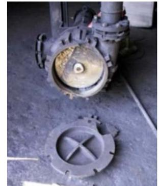
A resposta tem de ser “sim” ou nós não teríamos tema para este Beacon! As bombas centrífugas nas fotos são todas bombas de água que explodiram. As explosões não ocorreram devido a qualquer contaminação ou reacção química com qualquer substância que não era suposto estar nas bombas. De facto, explosões como esta, aconteceram com água muito pura – bombas de água de alimentação a caldeiras, bomba de condensados e bombas de água desionizada.
