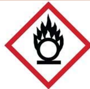
Simbolul oxidanților conform “Sistemului Global Armonizat de Clasificare și Etichetare a Substanțelor” al Națiunilor Unite)
