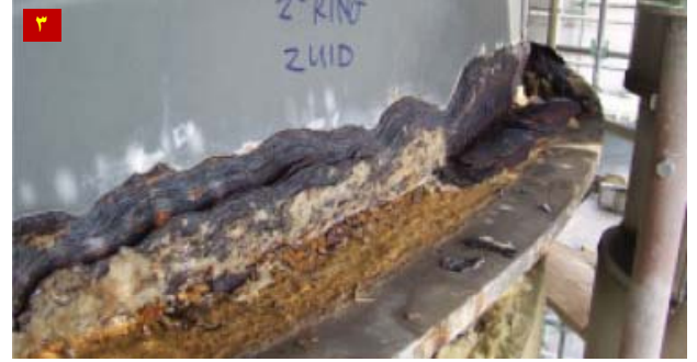
(١) و (٢) - أمثلة من العزل التالف (٣) - التآكل الناتج عن العزل التالف
