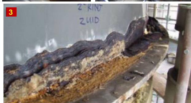
(1) ו- (2) – דוגמאות לבידוד שניזוק (3) – קורוזיה שנגרמה כתוצאה מבידוד שניזוק
