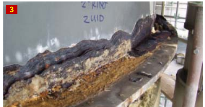
(1) dan (2) – Contoh kerosakan pada penebat (3) – Kakisan disebabkan kerosakan pada penebat
