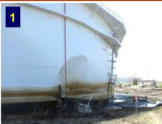
(1) Bể chứa bị hư hỏng và tràn vào con đê chặn
