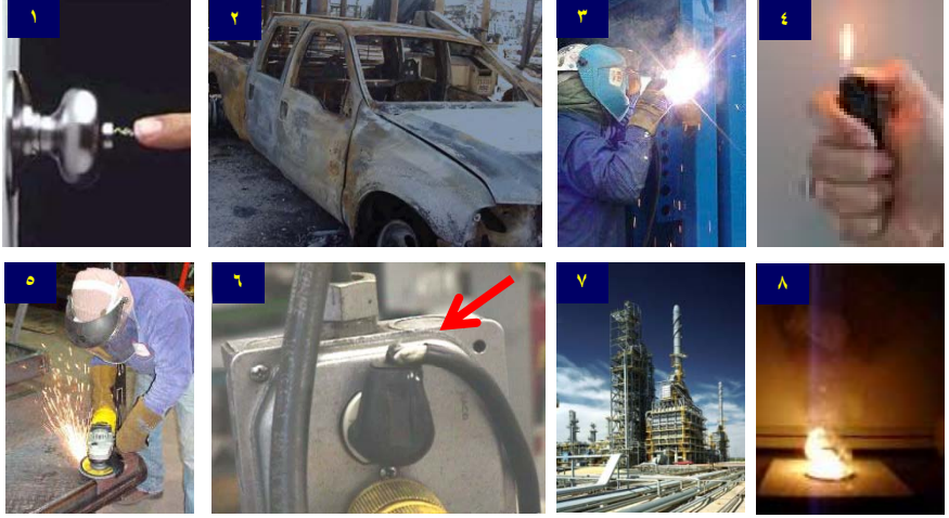
بعض الأمثلة من مصادر الاشتعال: (١) الكهرباء الساكنة، (٢) المركبات، (٣) اللحام، (٤) اللهب المكشوف، (٥) الطحن (٦) الأسلاك الكهربائية الخاطئة، (٧) الأفران، (٨) المواد التفاعلية الاشتعال أو المواد المتحللة
