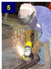
Příklady iniciačních zdrojů: (1) statická elektřina, (2) dopravní prostředek, (3) svařování, (4) otevřený plamen, (5) broušení, (6) poškozené elektrické kabely, (7) pec, (8) pyroforické nebo rozkládající se látky
