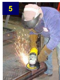
Mogelijke ontstekingsbronnen: (1) statische electriciteit, (2) voertuigen, (3) lassen, (4) open vuur, (5) slijpen, (6) verkeerde elektrische aansluiting, (7) fornuis, (8) pyrofore of ontleedende stof.
