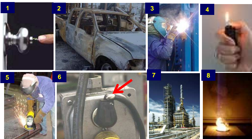
Παραδείγματα πηγών ανάφλεξης: (1)στατικός ηλεκτρισμός, (2)οχηματα, (3) ηλεκτροσυγκόλληση, (4) φλόγα, (5)τρόχισμα, (6) ελαττωματικά ηλεκτρικά καλώδια, (7) φούρνος, (8) πυροφορικά ή αυτοδιασπώμενα υλικά
