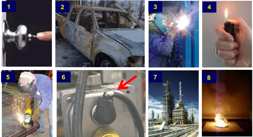
Alcuni esempi di fonti di innesco: (1) elettricità statica, (2) autoveicoli, (3) saldatura, (4) fiamme libere (5) lavorare alla mola, (6) impianto elettrico difettoso, (7) fornace, (8) decomposizione materiali piroforici.
