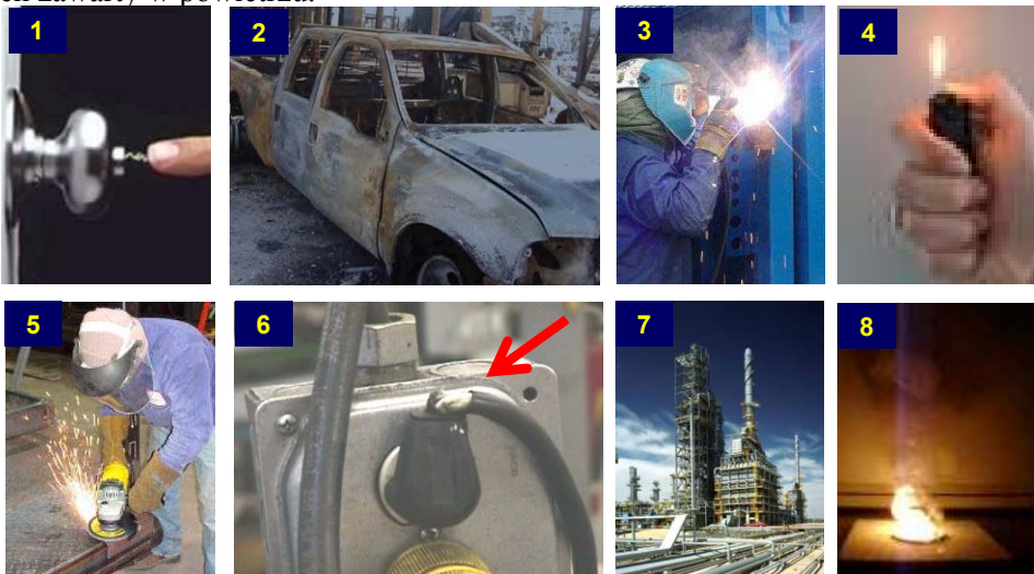
Kilka przykładów źródeł zapłonu: (1) elektryczność statyczna, (2) pojazdy, (3) spawanie, (4) płomień otwarty, (5) szlifowanie, (6) uszkodzony przewód elektryczny, (7) piec technologiczny, (8) materiał piroforyczny lub reaktywny
