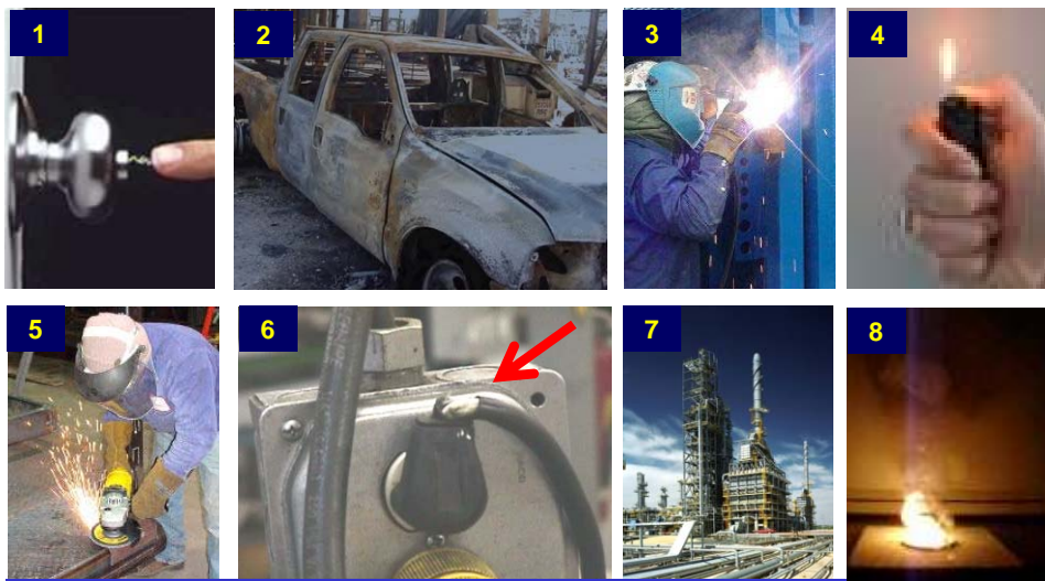
Câteva exemple de surse de aprindere: (1) electricitate statică, (2) autovehiculele, (3) sudură, (4) foc deschis, (5) polizat, (6) cabluri electrice defecte, (7) cuptor, (8) materiale piroforice sau de descompunere
