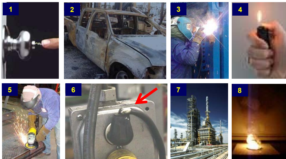
Некоторые примеры источников зажигания: (1) статическое электричество, (2) автомобиль, (3) сварка, (4) открытый огонь, (5) шлифовка, (6) неисправный электрический кабель, (7) топка котельной, (8) самовозгорающийся или распадающийся материал
