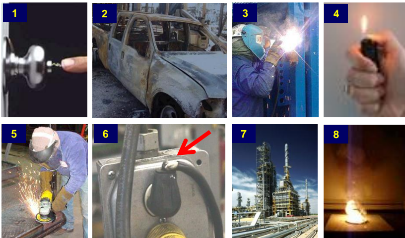
Một số ví dụ về nguồn lửa: (1) tinh điện, (2) xe, (3) hàn, (4) ngọn lửa trần, (5) mài, (6) hệ thống dây điện bị lỗi, (7) lò nung, (8) vật liệu tự cháy hoặc phân hủy
