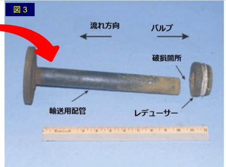
メチルメルカプタンや塩素ガスを積んだ他のタンク貨車が留め置きあるいは荷おろしされる区域で、毒性の可燃性ガス（沸点6°C）であるメチルメルカプタンを積んだタンク貨車の荷おろしを行っていた。荷おろしの作業中、タンク貨車の荷おろしバルブに取り付けられた2インチから1インチへのレデューサーに繋ぎこむパイプのねじ部が破損した。メチルメルカプタンが雲状に放出され、緊急対応要員が到着すると間もなく着火し、火炎が200フィートまで噴き上り、塩素用貨車の上にあった荷おろしに使うホースが破損した。2名の作業員が毒性ガスに曝され死亡し、3人目は毒性ガスに曝され更に火傷により亡くなり、その地域の住民約2,000名が避難させられた。貨車タンク内のメチルメルカプタンの全量(約15万ポンド)が放出され、約2万6千ポンドの塩素も放出された(図1)。両方の貨車ともに荷おろし用の繋ぎ込み部に過剰流出防止弁が付いていたが、流れを閉止できなかった。破損したパイプからの流出量が少なすぎて過剰流出防止弁を閉にできなかったと考えられている。
