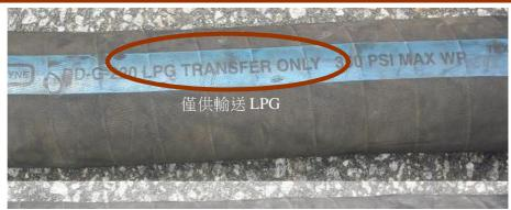
2009年7月某個清晨,在美國南卡羅來納州,一台液氨(anhydrous ammonia)槽車正使用拖車上所存放的軟管卸料到某工廠貯槽。在開始輸送後不久,卸料軟管便破裂了,釋放出氨(毒性氣體)蒸氣雲。蒸氣雲飄過高速公路,進入叢林地區,消散於此。高速公路上有位駕駛人駛入氨蒸氣雲中,顯然因而偏離車道。她被摔出車外,隨後死於吸入氨氣。有14位民眾舉報有身體不適的問題,有7名去治療呼吸道症狀,並在同一天出院。該地區的居民被告知要閉門避難,高速公路則封閉了好幾個小時。大約有7000磅氨外洩。
