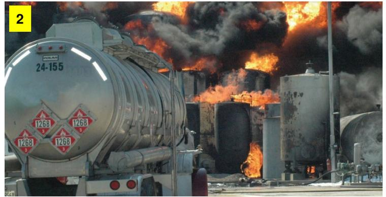
已經發生許多起事故，其中靜電放電可能是火災或爆炸的點火源。2007年有兩起事故被美國化學安全委員會（CSB）調查（註1）。一件是由於某中型散裝容器（IBC方桶，可搬運槽）在裝易燃性溶劑時接地不良所引起的（圖1），而另一件是由於儲槽正在從槽車加料時，儲槽內之液位浮球接地不良所引起的（圖2）。其他事故則是由於儲槽、可搬運容器、油罐車，鐵路槽車等之接地/導線連接（grounding/bonding）不良，以及從人身靜電放電所引起的。
