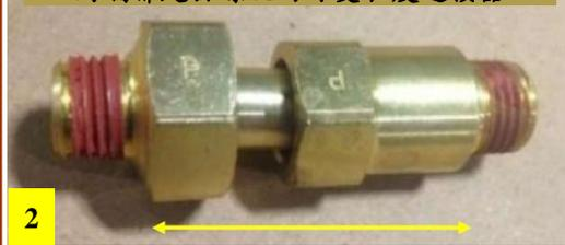
这艘轮船装备有四台柴油推进发动机（见图1）。燃油是通过一根带螺纹的可变长度连接器送到每个汽缸的（见图2）。每台发动机上有4个这样的连接器。当连接器的螺纹端旋进汽缸接口时，这种可延长连接器设计为安装提供了方便。这艘经历了发动机着火的轮船，其四台发动机中有三台已经更换成了橡胶软管和带螺纹的软管接头（见图3）。也就是在这些软管之中的一根出了故障，燃油就直接喷到了发动机排气口上，而炽热的排气口可能就是点火源。
