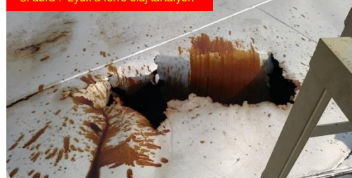
3. ábra: Lyuk a forró olaj tartályon
