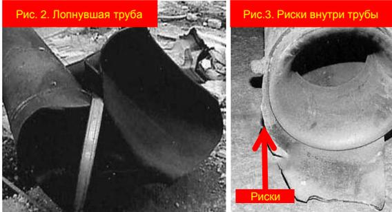
Рис. 3. Риски внутри трубы
