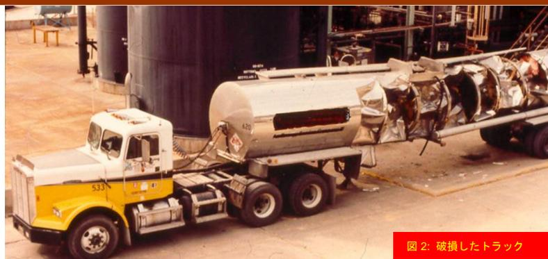
図2: 破損したトラック
