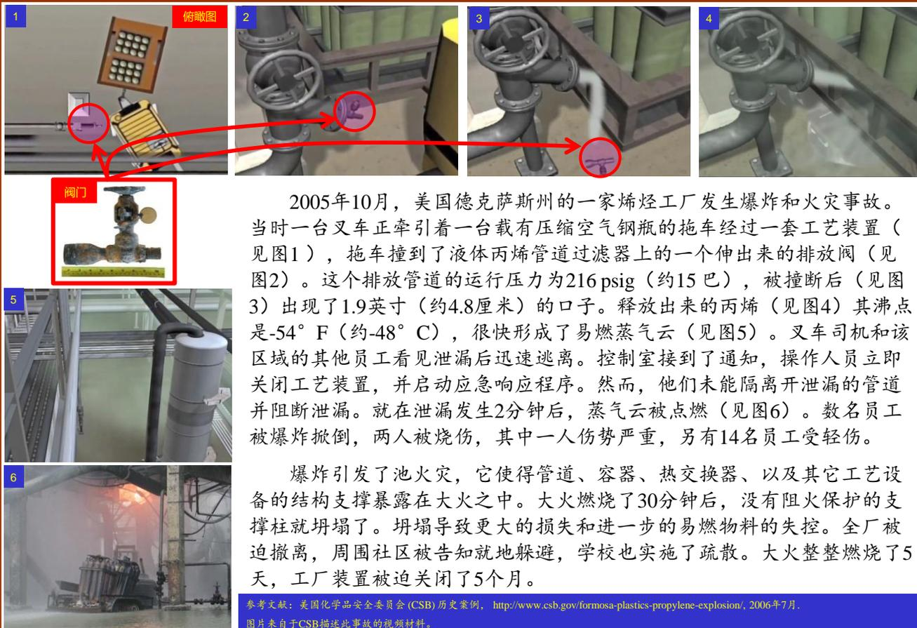
2005年10月，美国德克萨斯州的一家烯烃工厂发生爆炸和火灾事故。当时一台叉车正牵引着一台载有压缩空气钢瓶的拖车经过一套工艺装置（见图1），拖车撞到了液体丙烯管道过滤器上的一个伸出来的排放阀（见图2）。这个排放管道的运行压力为216 psig（约15巴），被撞断后（见图3）出现了1.9英寸（约4.8厘米）的口子。释放出来的丙烯（见图4）其沸点是-54° F（约-48° C），很快形成了易燃蒸气云（见图5）。叉车司机和该区域的其他员工看见泄漏后迅速逃离。控制室接到了通知，操作人员立即关闭工艺装置，并启动应急响应程序。然而，他们未能隔离泄漏的管道并阻断泄漏。就在泄漏发生2分钟后，蒸气云被点燃（见图6）。数名员工被爆炸掀倒，两人被烧伤，其中一人伤势严重，另有14名员工受轻伤。
