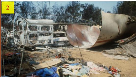
1948年7月、ドイツLudwigshafenの工場に、ジメチルエーテル(DME)を充填したタンク貨車が到着した。それは、約10時間直射日光に晒された後、溶接線が破損したと考えられている。死者約200名の内ほとんどが、漏れによって生じた可燃性DMEの蒸気雲爆発によるものだった。4000名近くが負傷し、その大多数は爆発によって損傷した施設から漏れ出した毒性物質への暴露によるものであった。(写真1)
