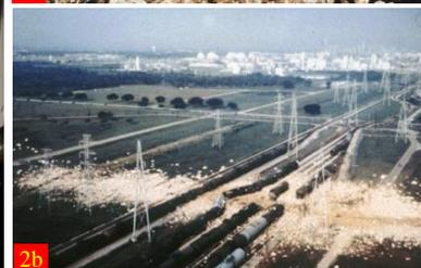
**事故2:** 一辆装载有粗制甲基丙烯酸（MAA）的铁路罐车被观察到有高温迹象，而且有物料从车上的安全阀喷了出来。该区域内的人员被紧急疏散，不久之后罐车发生了爆炸，罐车损毁，周边区域也遭到严重破坏（见图2a和图2b）。由于人员疏散及时，没有人员伤亡。
